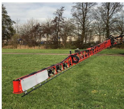
25cm rozstaw dysz na belce opryskowej HSS
