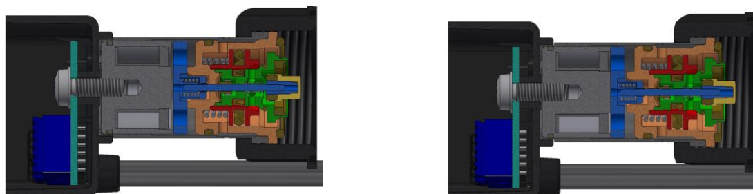
Otwarte bez zasilania (po lewej) / zamknięte z zasilaniem (po prawej)
