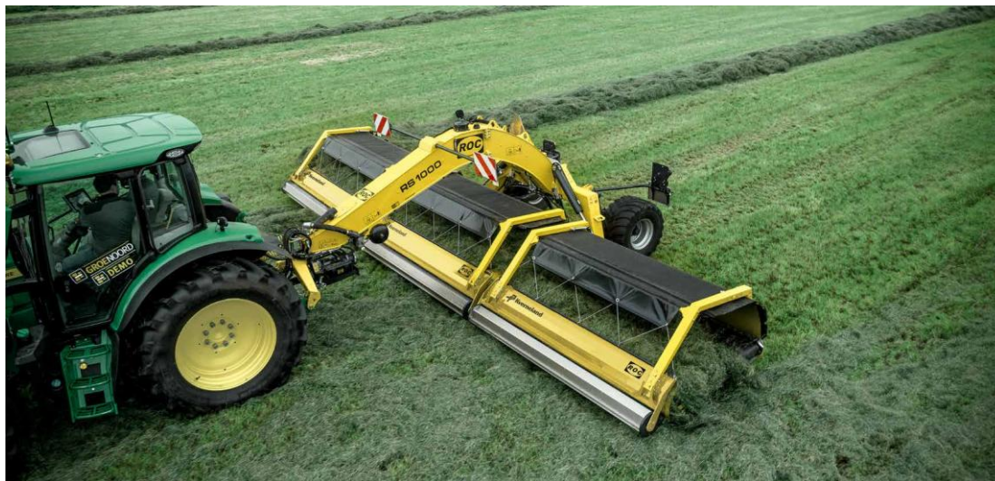
Kverneland ROC RS 1000/1150 w pracy na trzech niezależnych podbieraczach
